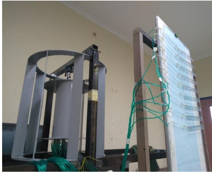
Gambar 21. Pembacaan tekanan statik pada permukaan bilah dengan manometer
